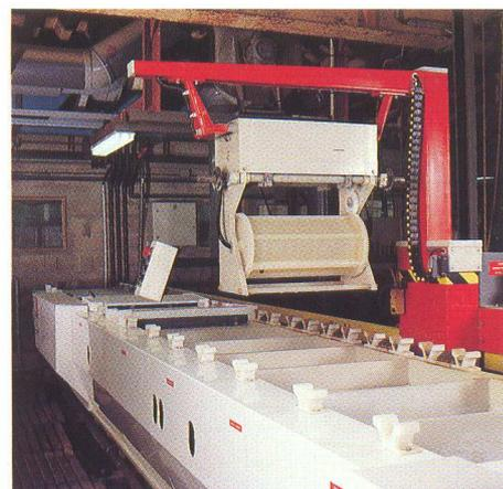
Chaîne de dépôt électrolytique
